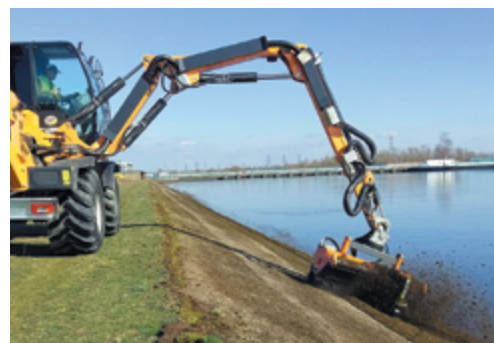
bema 25 mit Wildkrautbürste, Anbau Bagger (Sonderbau)
