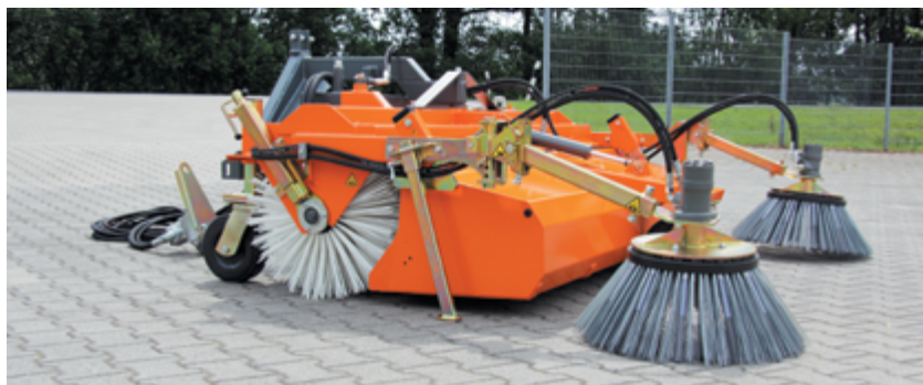
bema 25 Dual mit zwei Seitenkehrbesen - Wildkrautbesatz
