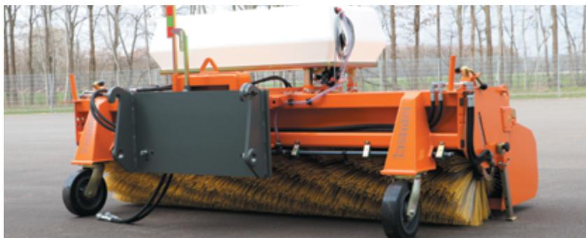
Schnellwechsellanbau mit Rollenniveaueingleich und bema-Meter
