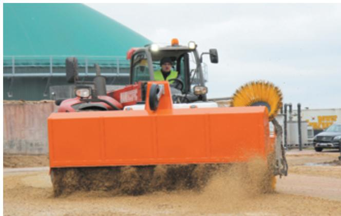
Freikehren auf der Biogasanlage mit der bema 75 Dual PowerMaster
