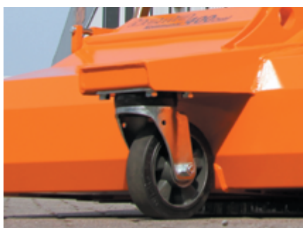
Schwerlastlaufräder Ø 160 x 50 mm
