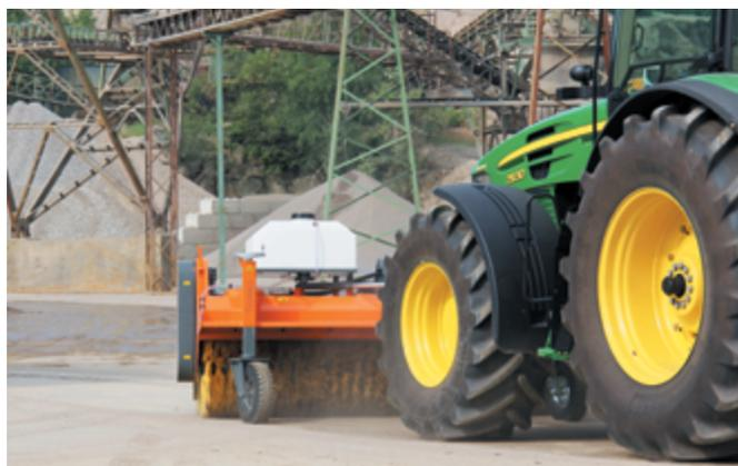
bema Jumbo angebaut am Schlepper (Front)
