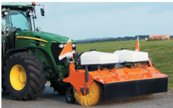
bema Jumbo angebaut am Schlepper (Front)
