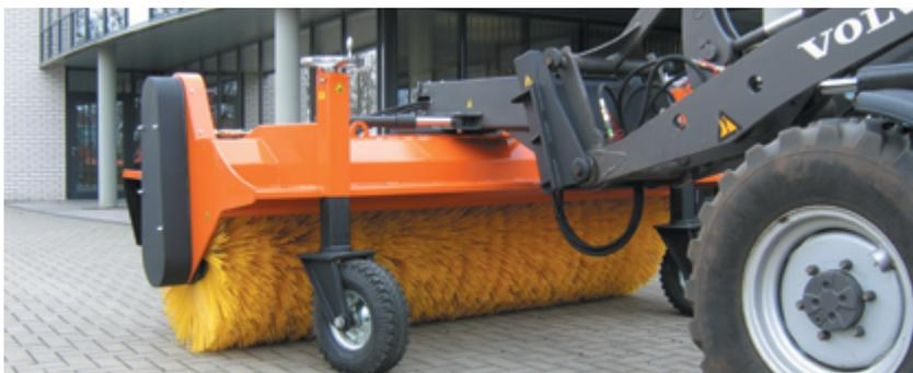
bema Jumbo am Radlader (Schnellwechselanbau mit Rollenniveaueingleich)
