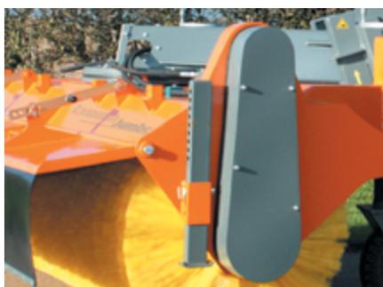
Kettenkasten (seitlicher Kettenantrieb)
