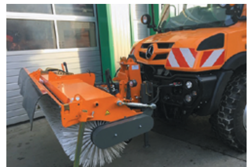
Unimog-Anbau, hydraulischer Aushub
