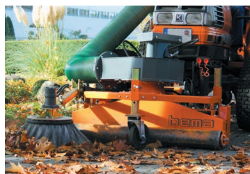
bema Saug-Kehrdüse mit Häckselgebläse
