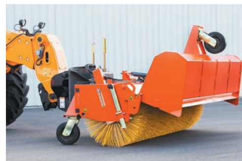
bema 30 Dual PowerMaster zamontowana na ładowarce kołowej, kosz zbierający „Dual” otwarty
