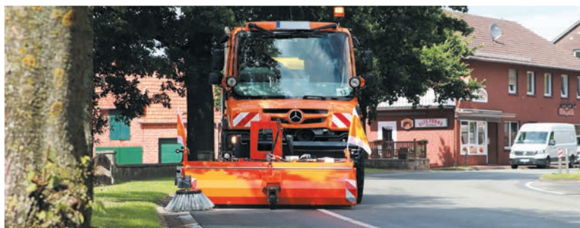
bema 30 Dual PowerMaster zamontowana na pojeździe Unimog ze szczotką boczną i hydraulicznym przesuwem bocznym (500 mm w prawo / w lewo)
