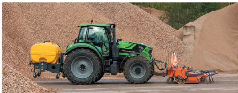
bema 35 Dual PowerMaster wyposażona w kosz zbierający „Dual” wraz ze zgarniaczem, wysokociśnieniowym systemem splukiwania, zbiornikiem na wodę z tyłu i certyfikowanym systemem kamer
