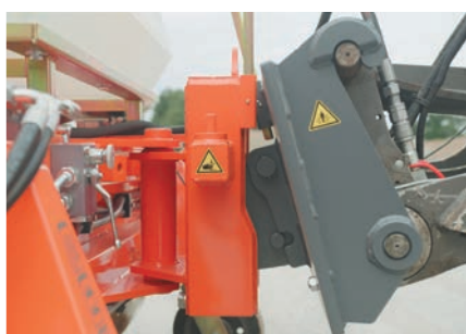
System kompensacji 3D i opcjonalny przegub obrotowy
