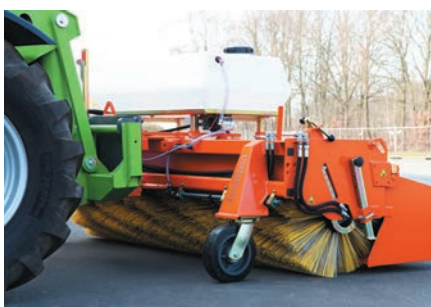
Solidne, superelastyczne koła jezdne Ø 300 x 90 mm, montaż na ładowarce teleskopowej
