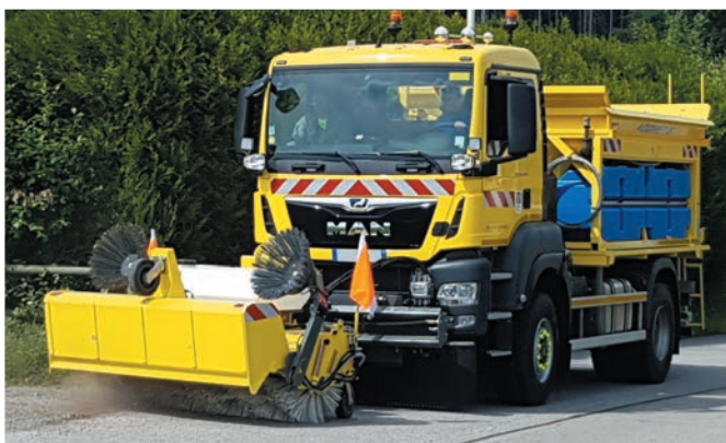
bema 35 Dual PowerMaster z hydraulicznym przesuwem bocznym (kosz zbierający otwarty / zamiatanie swobodne)
