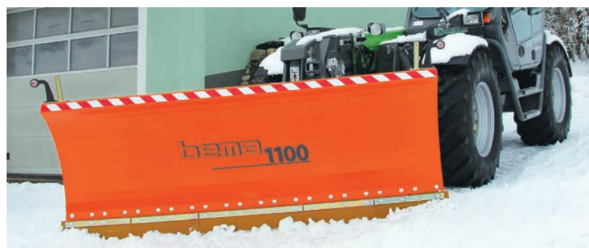
Pług śnieżny bema z serii 1100, zamontowany na ładowarce teleskopowej (system szybkiego montażu)
