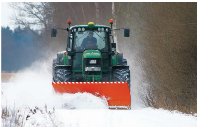
Pług śnieżny bema z serii 1100 na ciągniku (hydraulika czołowa)
